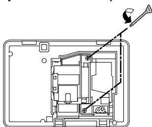
**4** Retire la lámpara usada.
