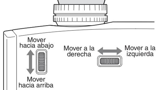
**Atención** Al transportar el proyector, asegúrese de bajar la posición de la lente al máximo. De lo contrario, el mecanismo de desplazamiento de la lente puede dañarse.
