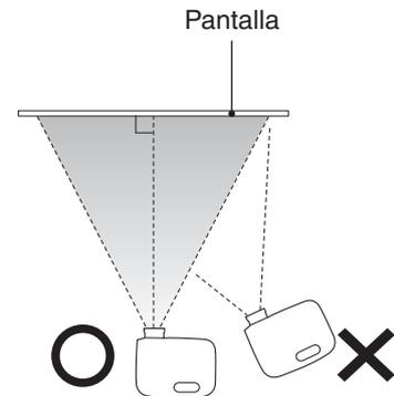
Instalar de manera que el proyector se encuentre paralelo a la pantalla. Si el proyector se instala en un ángulo a la pantalla, las imágenes pueden salir distorsionadas.
