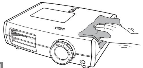
**Atención** No use sustancias volátiles tales como cera, alcohol o disolvente para limpiar el gabinete del proyector. Podrían causar que el gabinete se deteriore o que se estropee la terminación.
