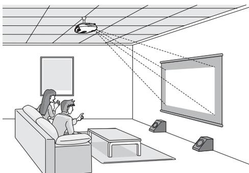
\* Si retira el proyector hacia un lado, apúntelo derecho hacia delante (en vez del centro de la pantalla), luego use el dial de ajuste de desplazamiento para centrar la imagen en la pantalla.
