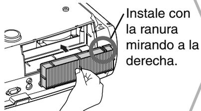
**5** Instale la cubierta del filtro de aire.
