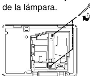
**7** Instale la cubierta de la lámpara.
